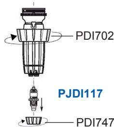
3. Desatornille la tuerca de seguridad (PDI746), remueva la arandela en forma de "C" (PDI751). Desatornille la manga de ajuste (PPDI037). Sujetando la manga (PDI805), empuje hacia arriba la parte del cono de inyección con rosquilla (PDI753) y sáquela completamente de la manga. Reemplace ambos o-rings, el de la manga y el del cono de inyección (JDI100 y JDI122).
